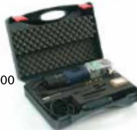
Handliche, tragbare Wolframschleifgerät zum perfekten und umweltfreundlichen Schleifen von 1,0–4,0 mm Wolfram-Elektroden. Eingebaute Absaugung mit leicht austauschbarem Filter. Excenter-Scheibe für dreifache Nutzung der Diamantscheibe. Lieferung in einem Transportkoffer, komplett mit Diamantschleifscheibe, Elektrodenhalter und Elektrodenklemmen für 1,6, 2,4 und 3,2 mm Elektroden.
