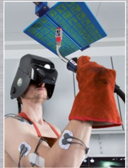
MB EVO PRO 36 in Schweißposition PE (Überkopfschweißen).
