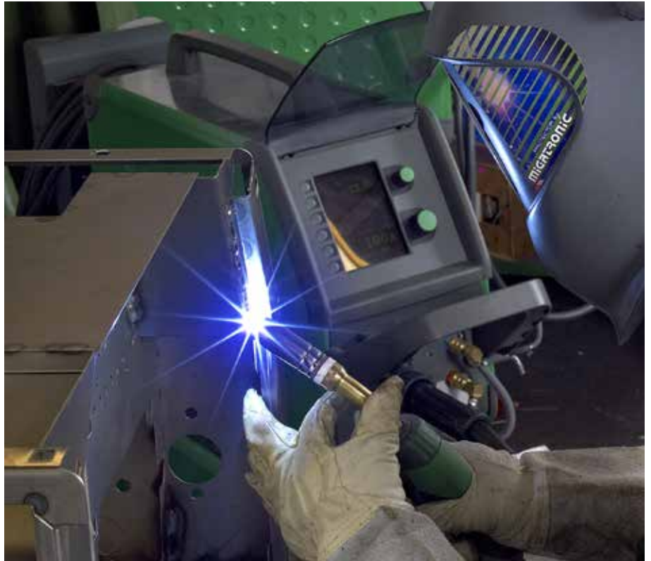
Die Sigma Galaxy ist mit einem leistungsstarken Computer ausgestattet, der den Prozess 50.000-mal pro Sekunde anpasst.
